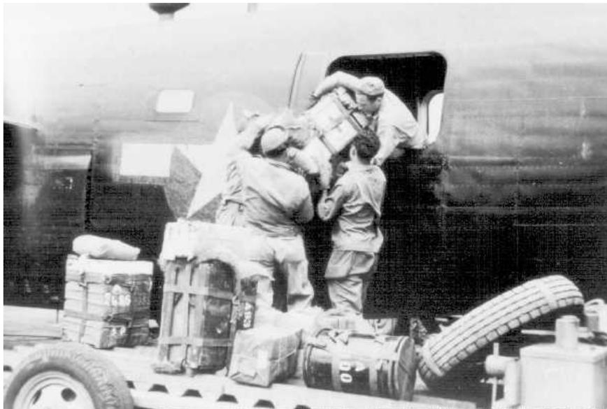
Les colis sont chargés à bord du B-24 à travers les baies des mitrailleuses de côté (Armement non installé)
